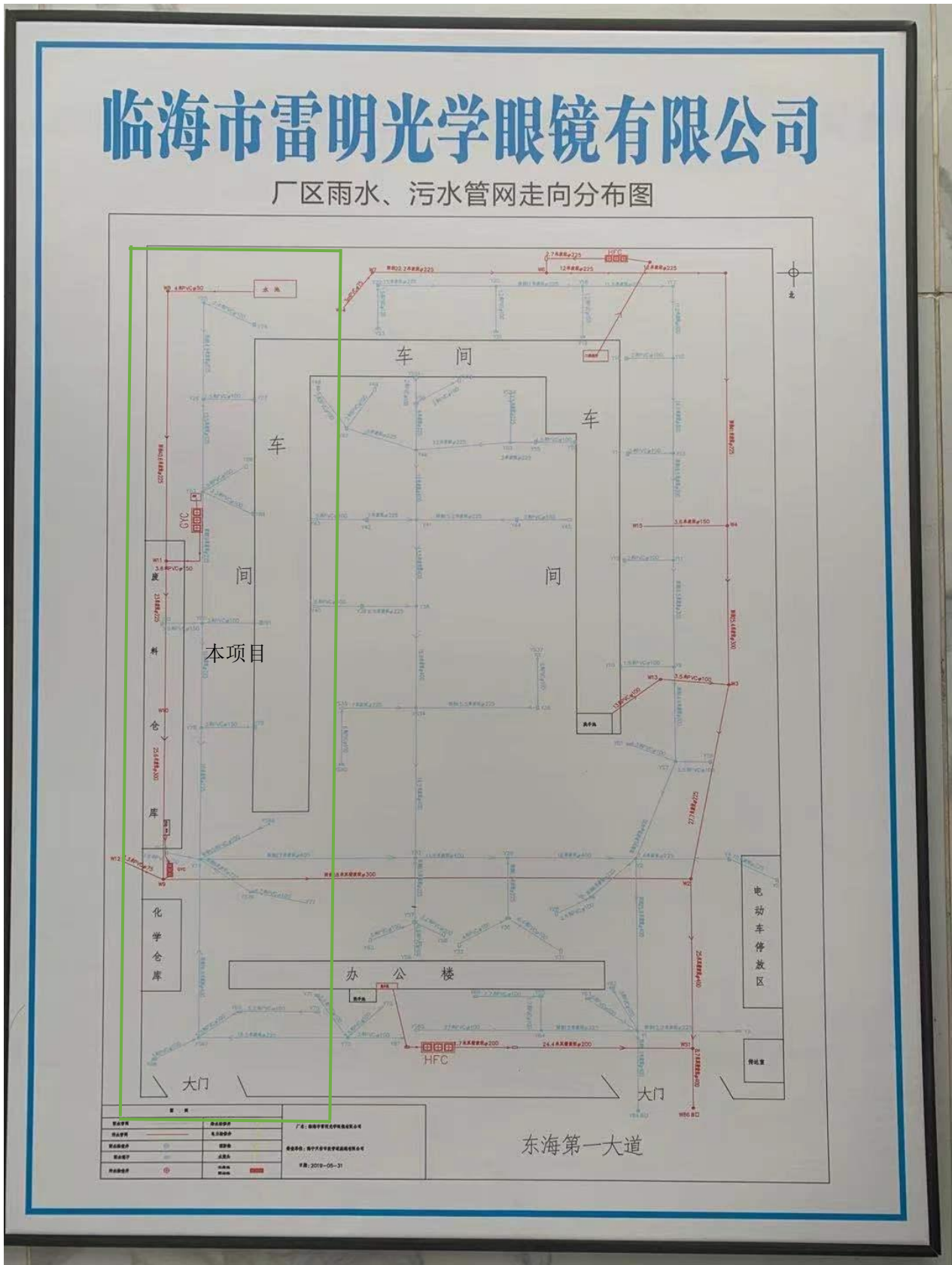
附图 2：雨污管网图
