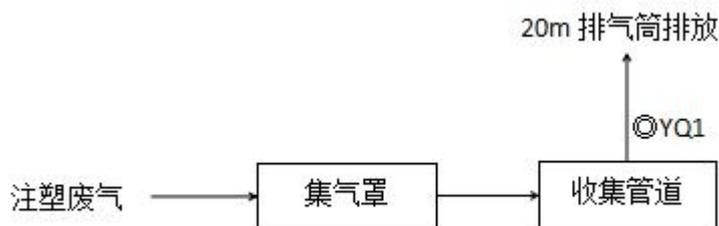
图 6-2 有组织废气监测点位图
