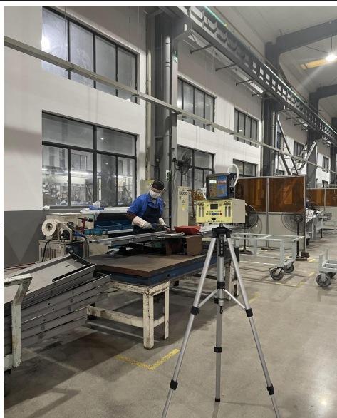
图 3 1#厂房气保焊岗位检测
