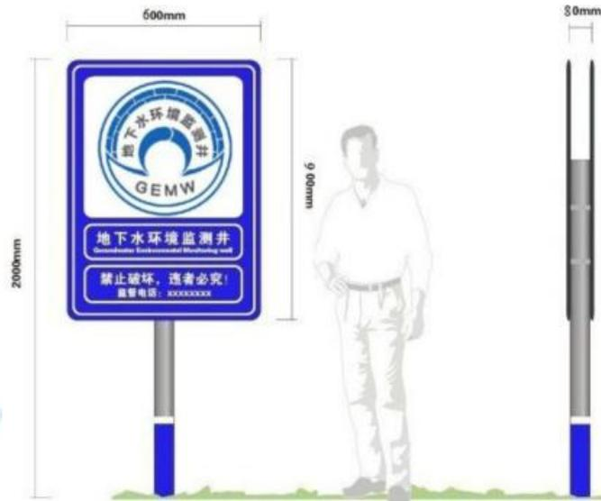
图 6.1-4 地下水监测井警示标图示及尺寸
